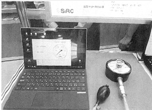
工場の機械式メータをIoT化するソリューション
